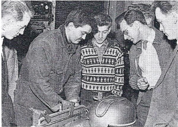
Bjørn Carstens, Gentofte, viser her medlemmer af Vespa Klub København, hvorledes man i en nødsituation kan klare udskiftningen af et fodbremsekabel.
