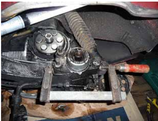
Fixering af bøjle for afspænding af kronemøtrik.
