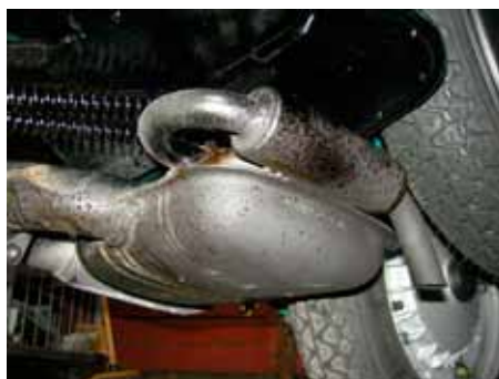
Den ekstra katalysator lydpotte svejset på afgangsrøret.
