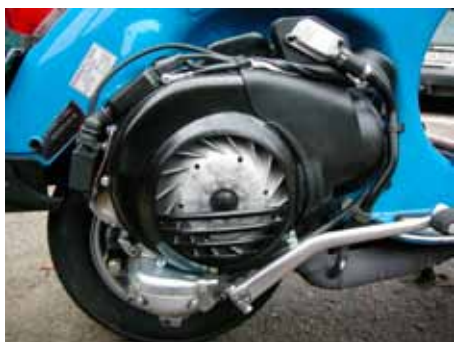
Den sekundære lufttilførsel til lydpotte monteret på forreste del af motoren.
